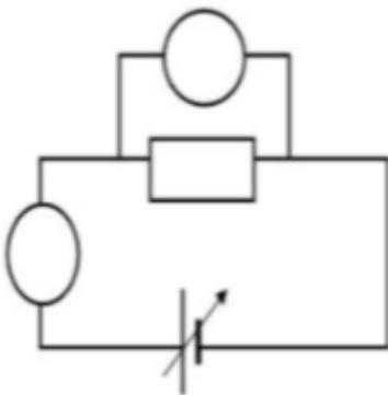
**Question 2 :** Compléter le tableau ci-dessous à partir des mesures faites en classe avec un résistor  $R = 33 \Omega$
