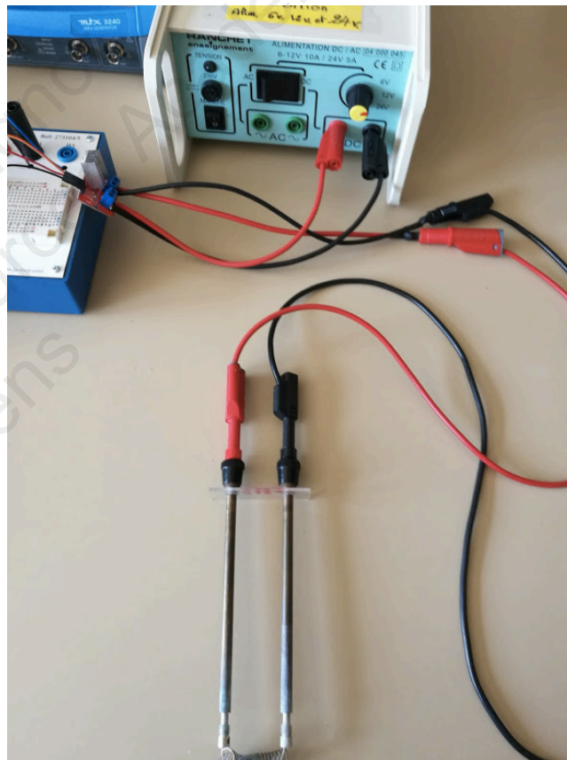
Le module MOSFET prend la place du relais sur la platine.
