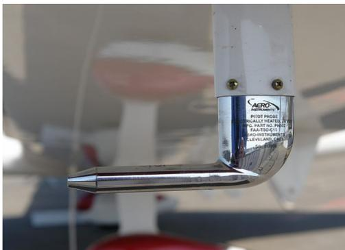
Tube de Pitot monté sur une aile d'avion
