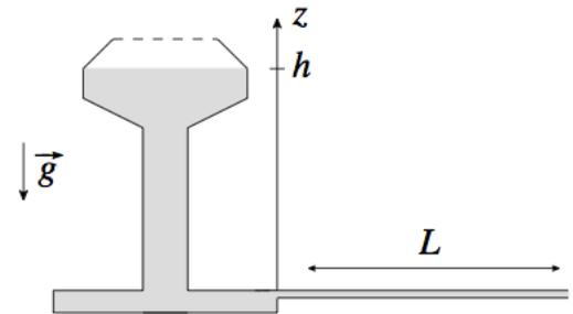
Le fluide s'écoule sous l'effet de la différence de pression qui existe entre l'entrée et la sortie de cette canalisation. Dans le cas d'un écoulement laminaire, il s'agit d'un écoulement de Poiseuille cylindrique pour lequel la vitesse vaut  $\vec{v}(M) = \frac{(P_e - P_s)(R^2 - r^2)}{4\eta L} \vec{u}_z$  où  $P_s$  est la pression de sortie.
